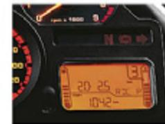
Le **système de contrôle de la pression des pneumatiques RDC** représente un gain de sécurité. Il informe le conducteur de la pression actuelle dans les pneus. Toute différence importante s'affiche automatiquement sur l'ordinateur de bord.
